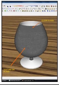
ガラス上のホコリを作成するため に、マテリアルのマット/フォンレ イヤーの拡散、反射、および透過 チャンネルにホコリのテクスチャを 適用します。*反射サンプリングを有* **効にし**、光沢の値を低く設定する必 要があります。
