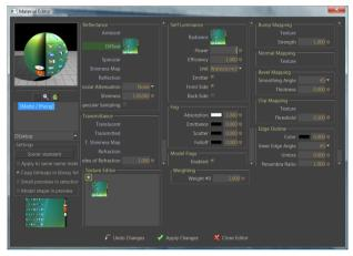
モニターの指紋を作成するために、誘電体ガラス のマテリアルの上に拡散テクスチャを重ねたレイ ヤードマテリアルを使用しますが、一工夫加えま す。
