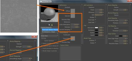
透過チャンネルには28のような低い値を設定 し、透過サンプリングを有効にします。
